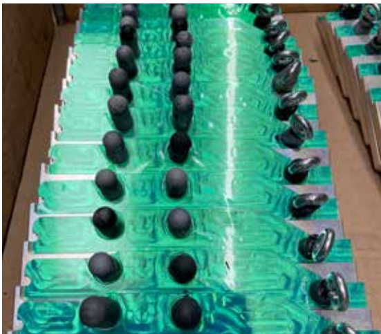
Abbildung 12: Maskierte Bauteile vor der Beschichtung
